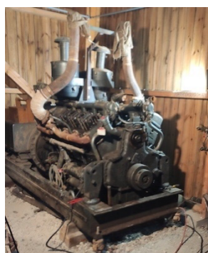
Tentative (difficile pour l'instant) de remise en route du moteur V12 Berliet de 550 CV, année 1957. L'Association de la Fondation Berliet a été sollicitée pour résoudre les problèmes posés.
