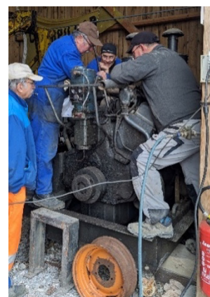
Tentative (difficile pour l'instant) de remise en route du moteur V12 Berliet de 550 CV, année 1957. L'Association de la Fondation Berliet a été sollicitée pour résoudre les problèmes posés.
